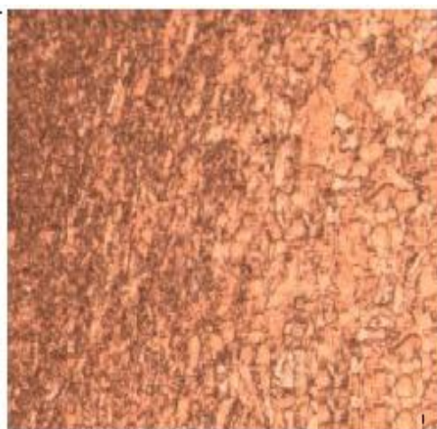
Fig.4.2 (d).Microstructure of TMAZ of RS
