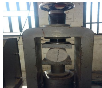
Fig. 4 Split tensile test
