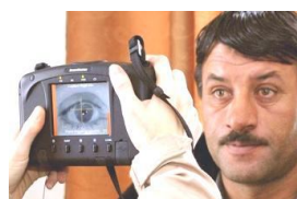
(A) (B) (C) (D) (a) Iris Capturing devices (b) Handheld Iris Scanner (c) Captured iris Image (d)
