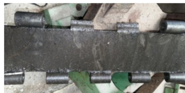
Fig. 11 Torn Hinge Loops
