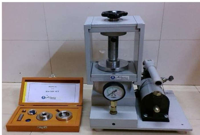
Fig. 3 KBr die set with hydraulic press
