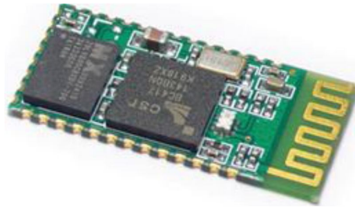
Fig. 1. HC-05 Bluetooth Module
