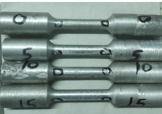
Fig. 3.4 Tensile test specimens
