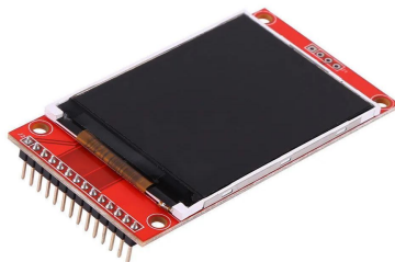
Fig. 3a Front side TFT SPI display
