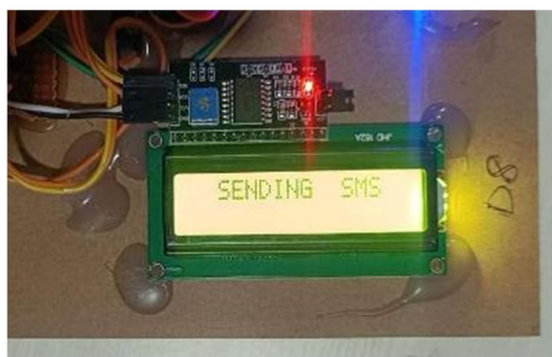
Fig 10.0: GSM module sending message
