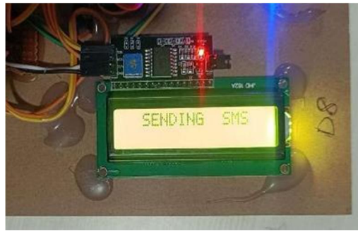
Fig 10.0: GSM module sending message
