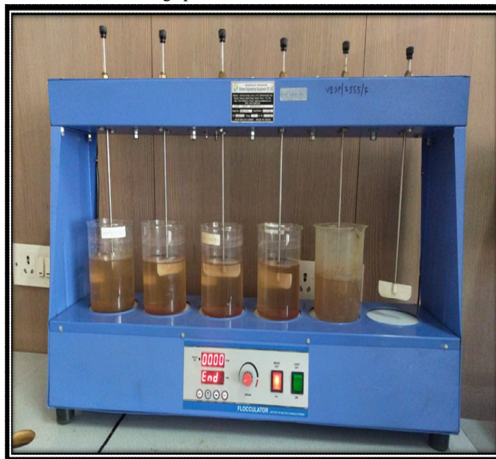
Fig. 3 Jar Test Apparatus
