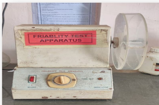
FIG.No. 6: Roche Friability Apparatus
