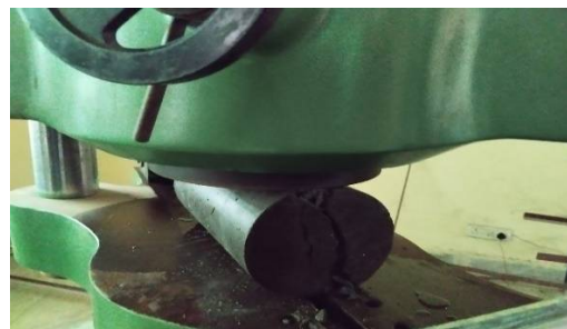
Figure- 2(Split Tensile Test)
