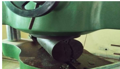
Figure- 2(Split Tensile Test)
