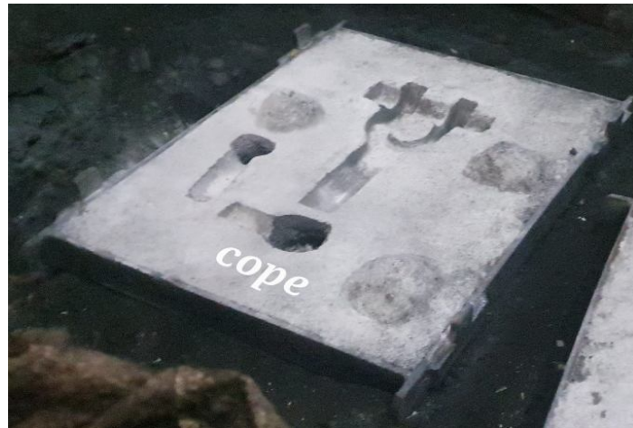
Fig. 11 Actual model of Cope
