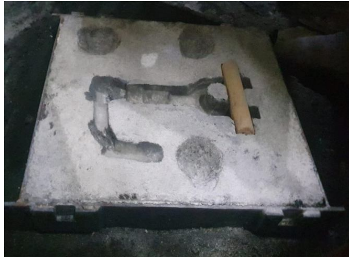
Fig. 10 Actual model of Drag
