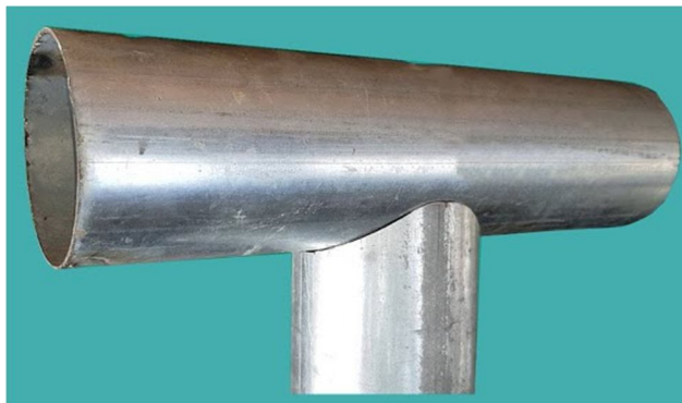
Fig: 7.1.2: Tube notching
