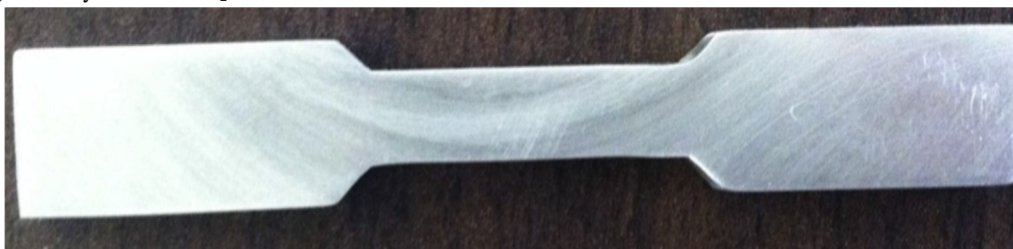
Fig.1. Tensile test piece.
