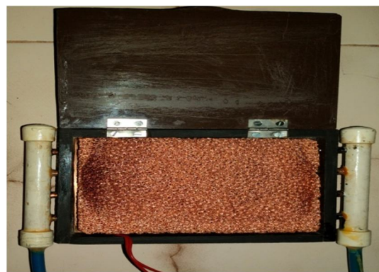
Fig 2. Actual heating section
