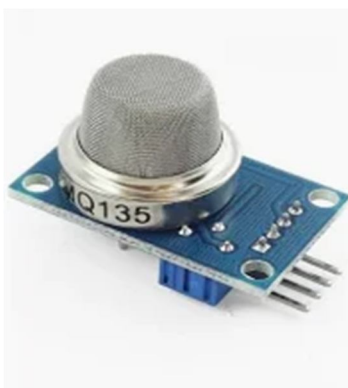
Fig 1: - MQ135 Gas sensor [7]
