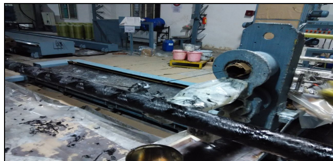
Fig -6: Actual Filament winding process
