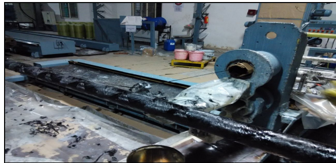
Fig -6: Actual Filament winding process
