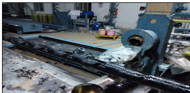
Fig -6: Actual Filament winding process
