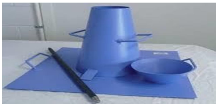
Fig. 5 – Slump cone apparatus
