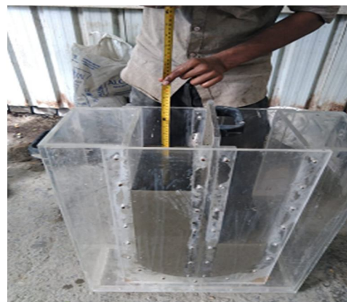
Fig 4. U- Box Test
