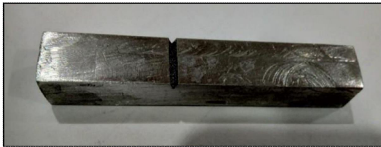
Fig. 4 Aluminium 6061-T6 Izod Test Specimen
