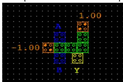
Fig. 2 XOR gate QCA layout
