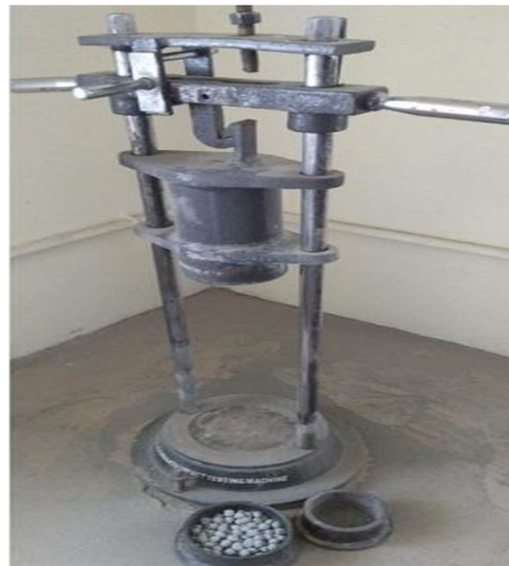
FIG. :-2 Impact Test Appratus
