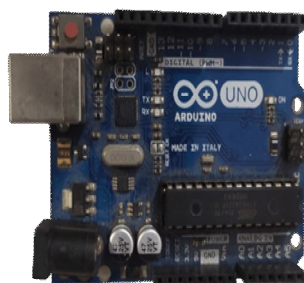
Fig -3: Arduino Uno
