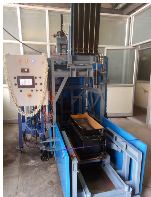
Fig 2: Roller Compactor um Rut Analyzer (RCRA)
