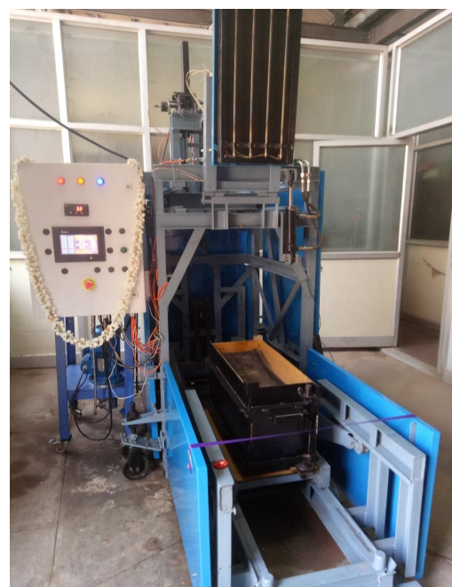
Fig 2: Roller Compactor um Rut Analyzer (RCRA)
