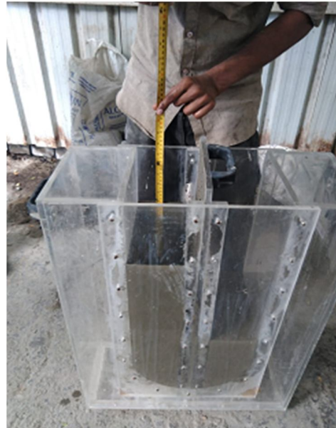
Fig 6. U- Box Test
