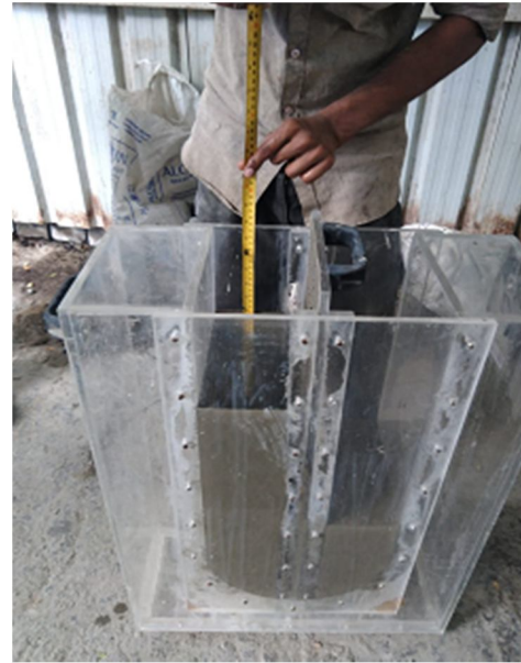
Fig 6. U- Box Test
