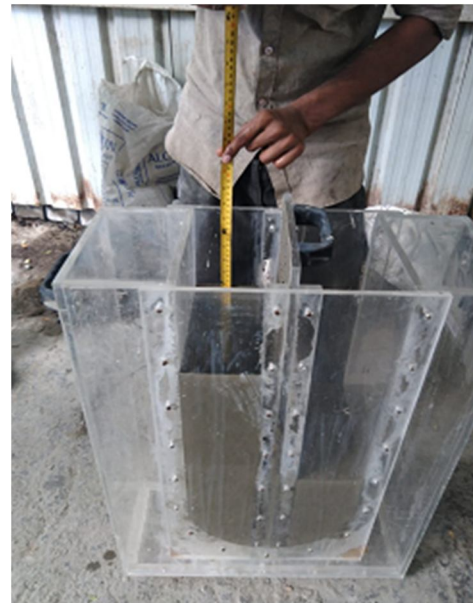
Fig 6. U- Box Test
