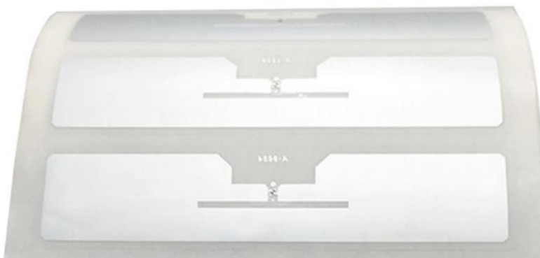
Fig. 6 Passive UHF RFID tags
