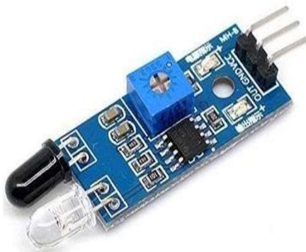
Module Diagram for IR Sensor
