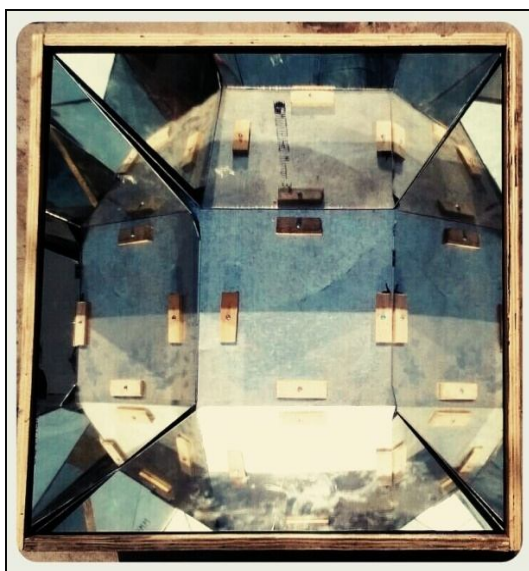
Fig. 3: Trapezium Solar Cooker
