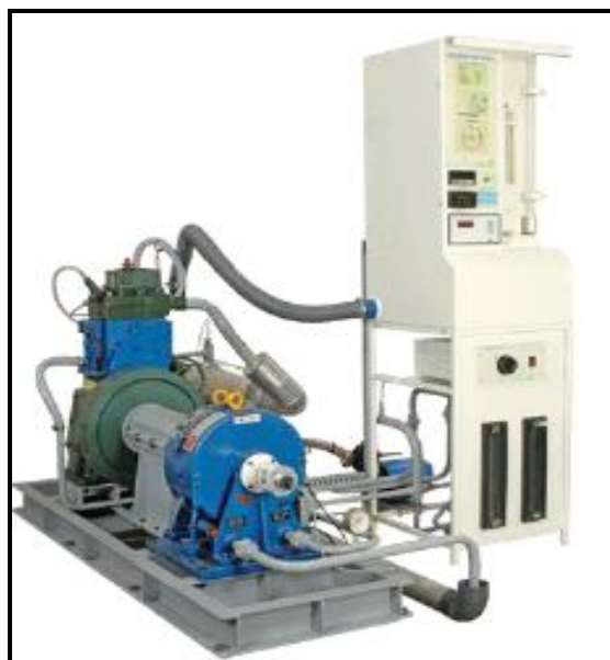
Fig. 2: Actual Setup of Engine Test Rig. [10]
