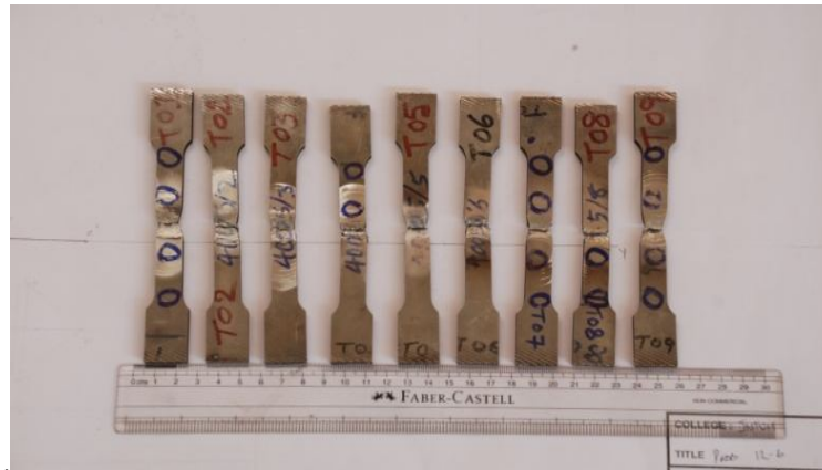
Fig. 3 Tensile test specimens
