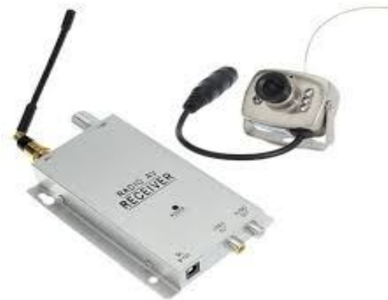
Fig 3 Wireless Camera with AV receiver
