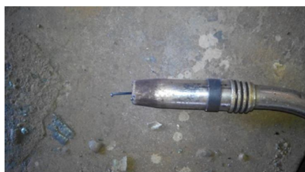
Fig. 1 mig welding gun
