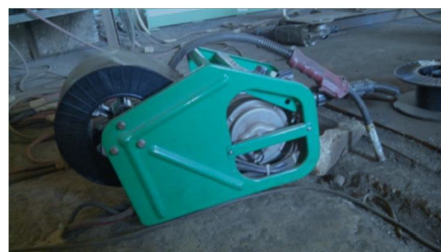
Fig. 2 mig welding apparatus
