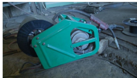
Fig. 2 mig welding apparatus
