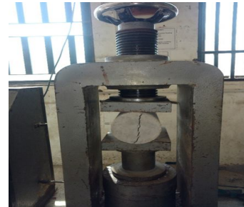
Fig. 4 Split tensile test
