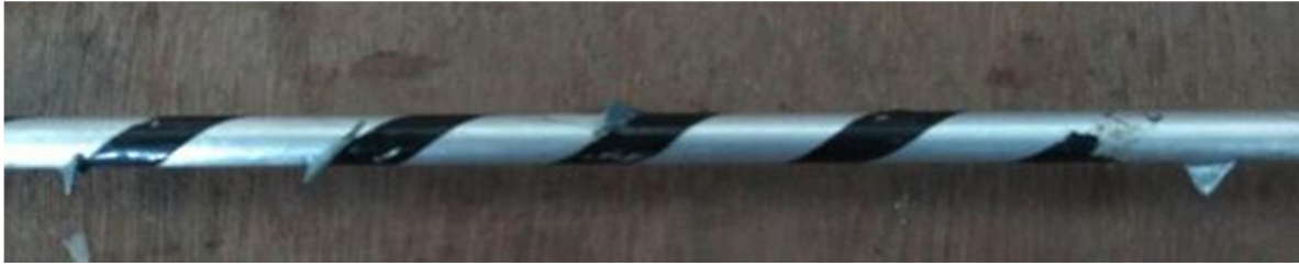
Fig. 5 Triangular fin type insert
