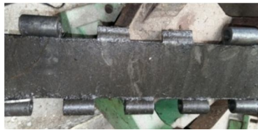
Fig. 11 Torn Hinge Loops
