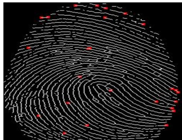
7. Minutiae Positions after Removing False Minutiae
