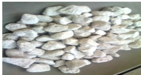
Fig: 3.1 Light weight Aggregate (Pumice)
