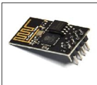
Fig: 4 ESP8266-01 IOT Sensor Module
