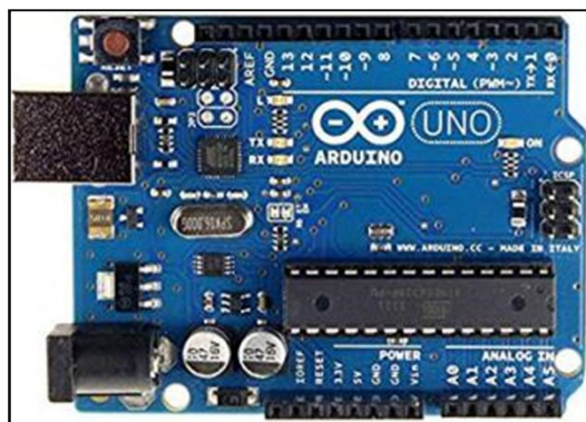
Fig: 3 Arduino Uno Microcontroller Board
