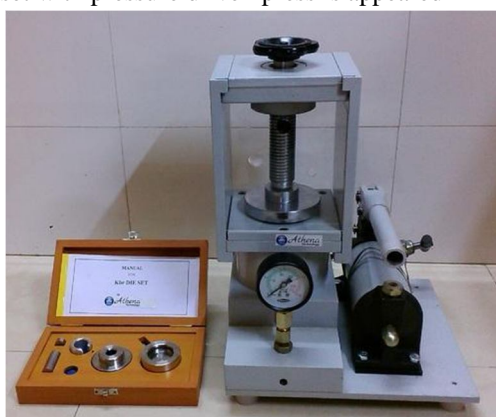
Fig. 5 KBr die set with hydraulic press
