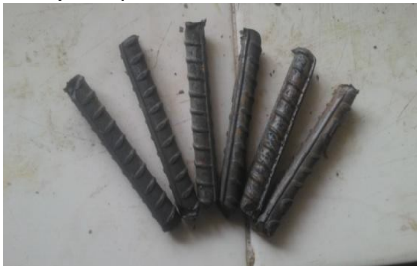
Fig. 2 HYSD bar specimen
