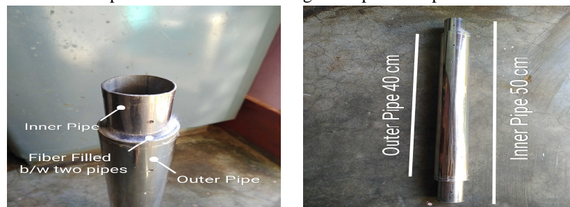
Fig.: Pipe assembly
