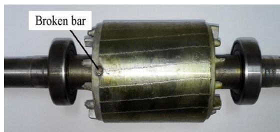
Fig.4 Broken rotor bar
