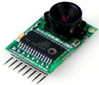
Fig. 8 ArduCAM Mini Camera
