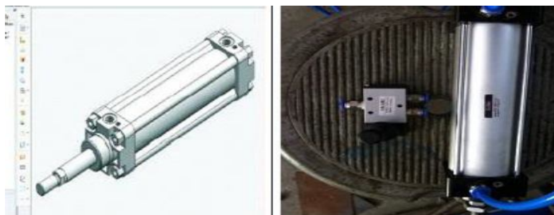
Fig. : Double actuating cylinder.
