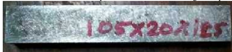
Fig 2 Tungsten carbide work piece
