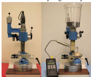
Fig 4 Degusa F1 Milling machine modified [4]
