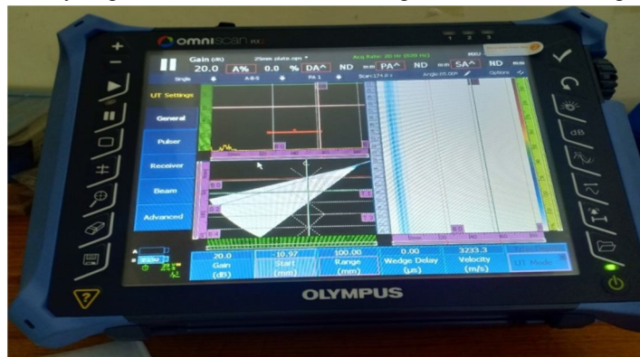
Fig. 9 PAUT Olumpus Omniscan MX2 Machine Display
