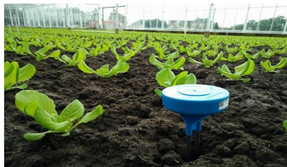
Actual Image of Soil Moisture Sensor.
