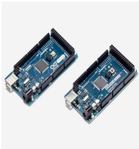
Fig.7 Arduino MEGA 2560microcontroller.
